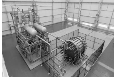
Máy điện phân kiềm điều áp do Nordex chế tạo
